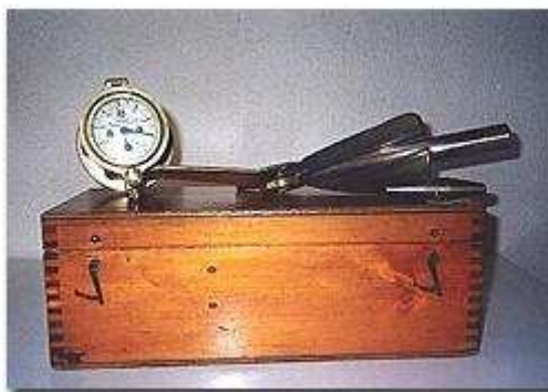
Fig. N° 1 ("Ejemplo de corredera analógica. Sensor e indicador")
