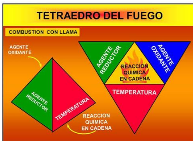
Figura 3: Gráfico o ecuación representativa del triángulo del fuego y la reacción de combustión exotérmica de un hidrocarburo.
