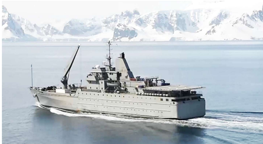
Figura 7.13 – Patrón de olas transversales a lo largo del casco del Transporte “Aquiles”.
