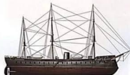
Fragata Blindada Independencia (1866) Desplazamiento: 3.300 Toneladas Art. Principal: 1 Cañón de 250 lb, 3 de 150 lb Blindaje: Max. 114 mm Velocidad Max: 11 Nudos
