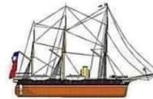
Corbeta Esmeralda (1856) Desplazamiento: 854 Toneladas Art. Principal: 16 Cañones de 32 lb Blindaje: Casco Madera Velocidad Max: 8 Nudos
