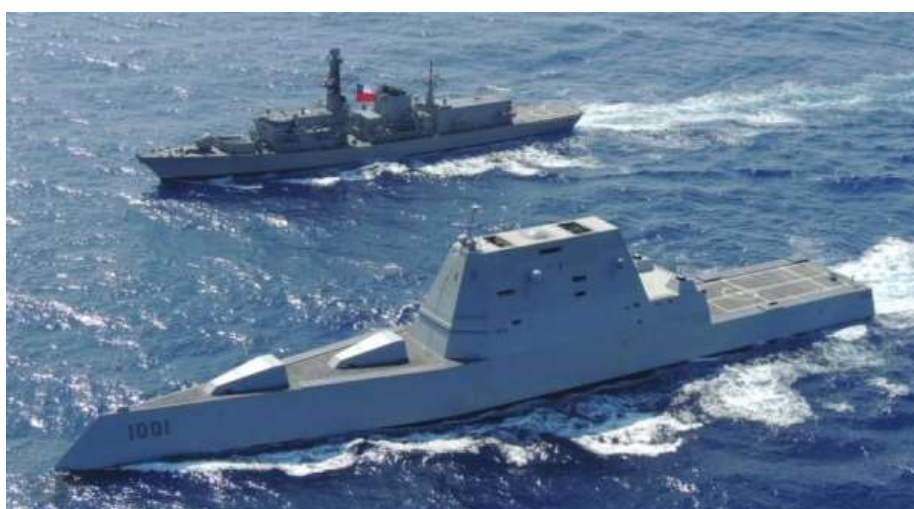
Figura 2.11 Sección afinada (Flare) y ensanchadas o gruesa (Tumblehome)
