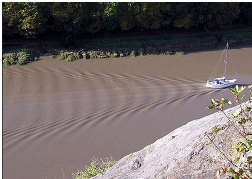
Figura 7.12 – Patrón de olas creado por la estela de una embarcación. Nótese los patrones de olas divergentes que emanan de su casco.
