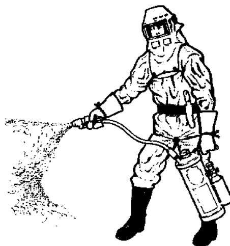
Fig. 5 Extintor de Polvo Químico Seco P12
