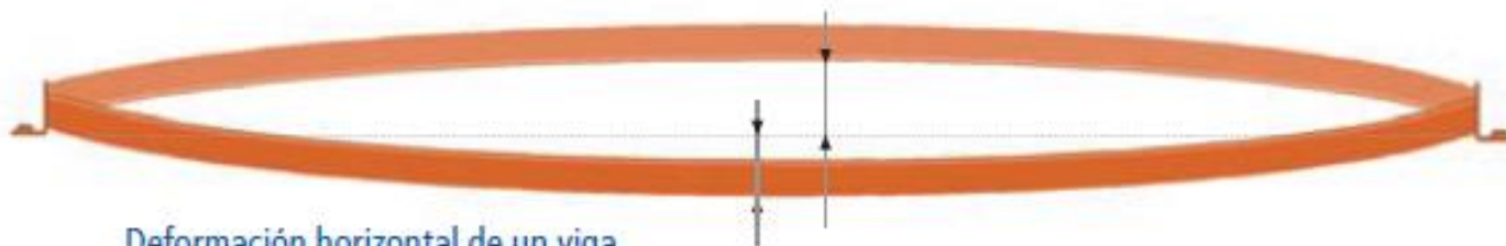
Deformación horizontal de un viga
