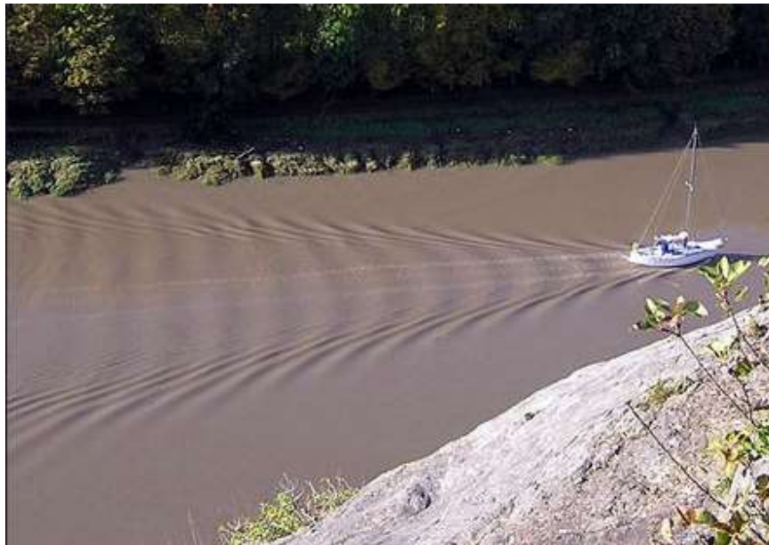
Figura 7.12 – Patrón de olas creado por la estela de una embarcación.
