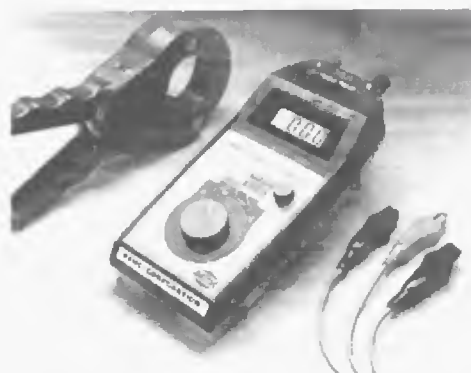
FIGURA 19.31 Medidor de gancho para identificar el factor de potencia. (Cortesía de AEMC Corporation.)
