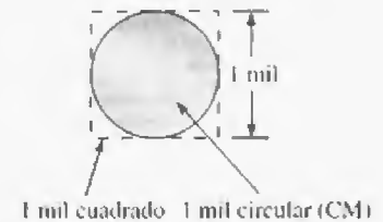
FIGURA 3.4 Definición del mil circular (CM).
