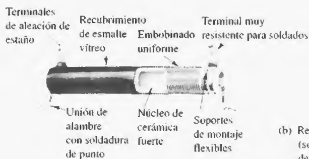
(a) Resistor de alambre embobinado de esmalte vítreo Aplicaciones: Todo tipo de equipos
