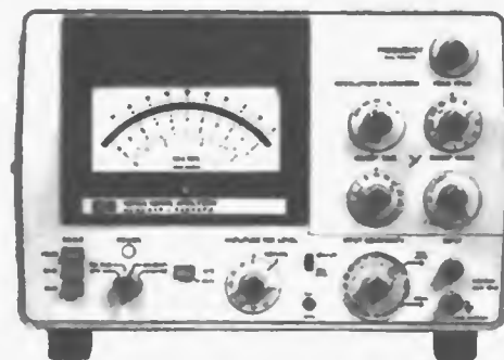
FIGURA 25.9 Analizador de onda. (Cortesía de Hewlett Packard.)
