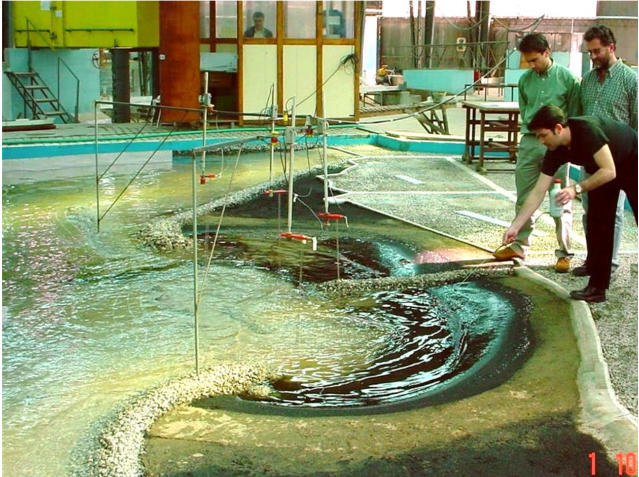
Ilustración 35; Modelación física de la morfodinámica de Playa Lisera, desarrollada en el Instituto Nacional de Hidráulica, Peñaflo.
