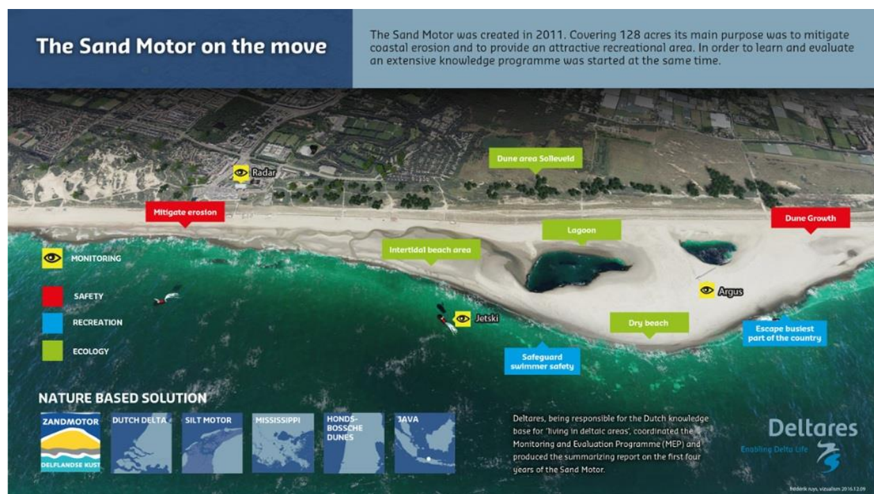
Ilustración 91: Alimentación artificial, denominada “Sand motor”), ejecutada en 2011 en las cercanías de La Haya, en los Países Bajos.
