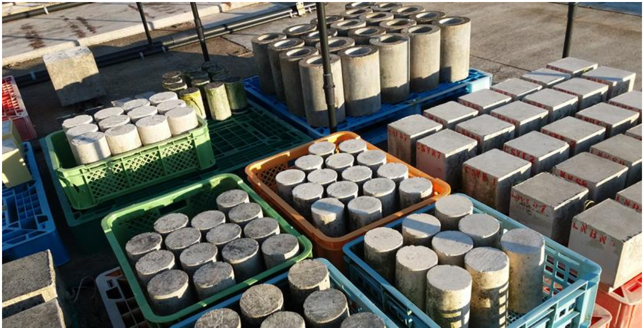
Ilustración 102: Testigos de hormigón sometidos durante décadas a un ambiente salino en el Port and Airport Research Institute, PARI, en Japón.
