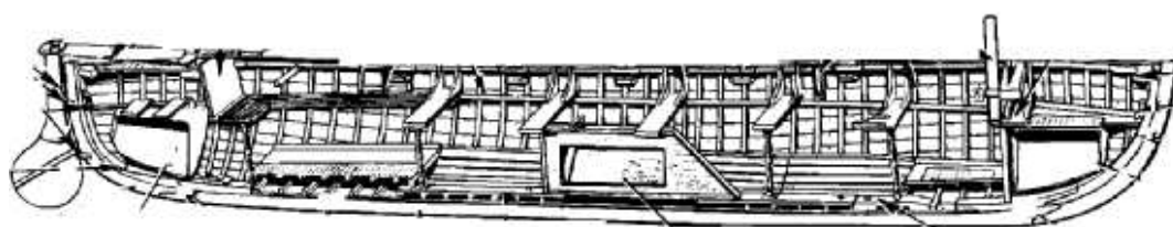
Fig. 9-9 Vista longitudinal de una chalupa de tingladillo.
