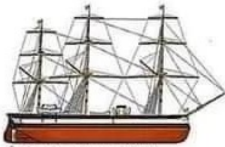
Corbeta Chacabuco (1868) Desplazamiento: 1.101 Toneladas Art. Principal: 3 Cañones de 115 lb Blindaje: Casco madera Velocidad Max: 10 Nudos
