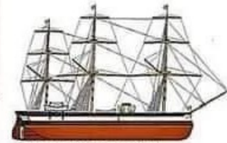
Corbeta O'Higgins (1868) Desplazamiento: 1.101 Toneladas Art. Principal: 3 Cañones de 115 lb Blindaje: Casco madera Velocidad Max: 10 Nudos
