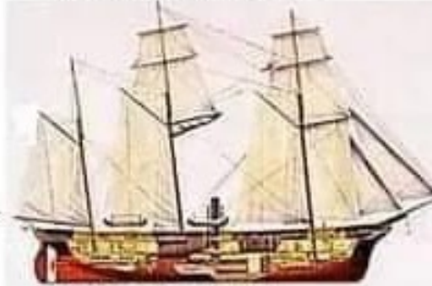
Corbeta Abtao (1866) Desplazamiento: 1.600 Toneladas Art. Principal: 3 Cañones de 150 lb Blindaje: Casco madera Velocidad Max: 10 Nudos
