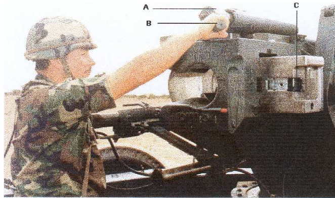
A.- ANILLOS DE PRESIÓN POSICIÓN DE TRABAJO. B.- ACCIONADOR DE MANIVELA DE MANIOBRA. C.- MECANISMO DEL CIERRE ABIERTO.
