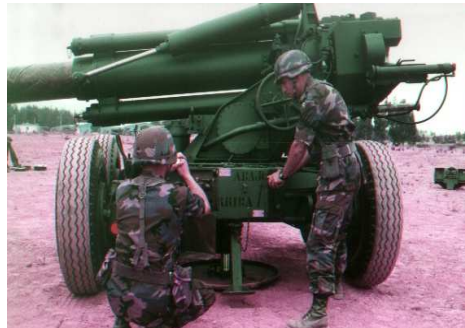
FLECHAS POSICIÓN DE MARCHA, TUBO A 90° SIRVIENTES TRABAJANDO PALANCAS DEL HIDRÁULICO Y GATA MECÁNICA PARA SUBIR LA PLACA BASE.
