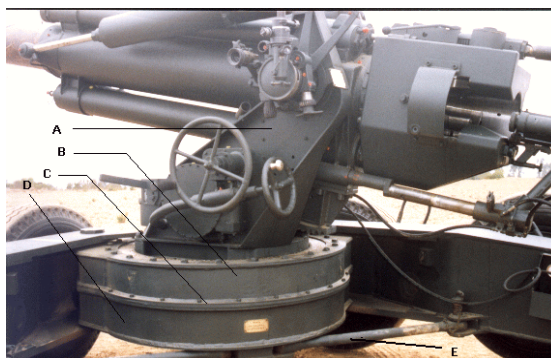
A.- HORQUILLA B.- CUADERNA SUPERIOR C.- UNIÓN DE CUADERNAS D.- CUADERNA INFERIOR E.- FIJADORES DE LAS FLECHAS
